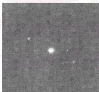
ภาพที่ 4.26 ภาพถ่ายจุดเลี้ยวเบนของชั้นโครงสร้างรอยต่อหลังจากทำการอบแอนนีลที่อุณหภูมิ 550^{\circ}\text{C} เป็นเวลา 1 นาที บริเวณชั้นที่ 1, 2, 3 และ 4
