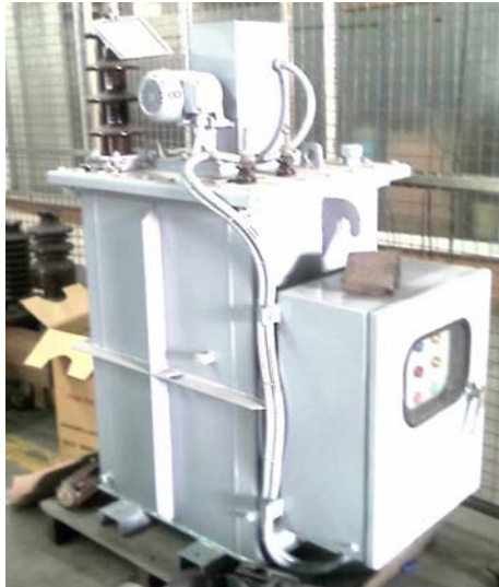
รูปที่ 3.7 หม้อแปลงเรโซแนนซ์
