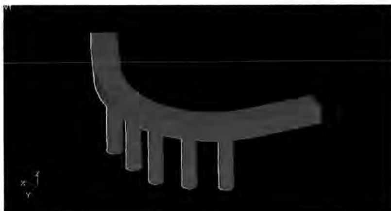
ภาพที่ 3.9 แสดงภาพด้านข้างและด้านบนเฉพาะส่วนแบบจำลองไฟไนต์เอลิเมนต์ของรากเทียม, หลักยึด และส่วนโครงโลหะของฟันปลอมไฮบริดเป็นรูปคานโค้ง
