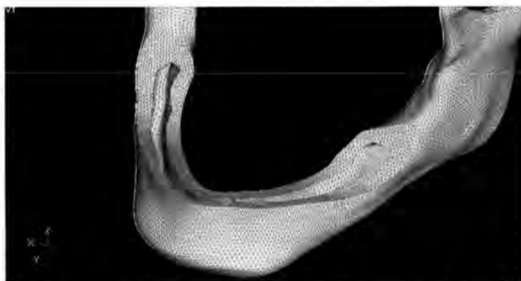
ภาพที่ 3.17 แสดงแบบจำลองซากกรรไกรล่าง ภายในถูกแบ่งเป็นเอลิเมนต์ย่อยรูปสามมิติทรงเหลี่ยมสี่หน้า (tetrahedral)
