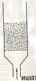
รูปที่ 3.3.3 ฟลูอิดไดซ์เบดที่ของไหลเป็นของเหลว
