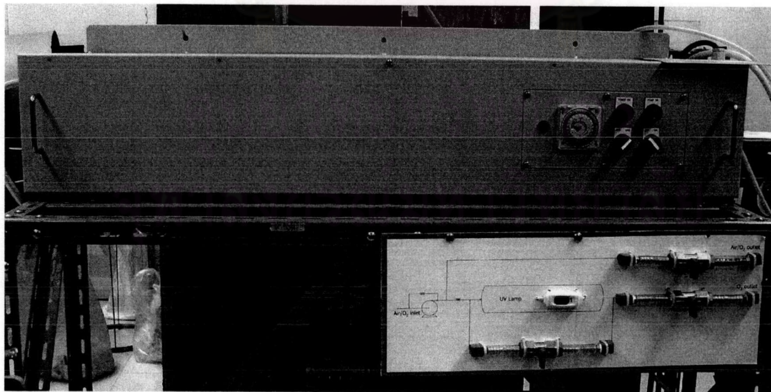
รูปที่ จ.2 เครื่องผลิตโอโซนที่ใช้ในการทดลอง
