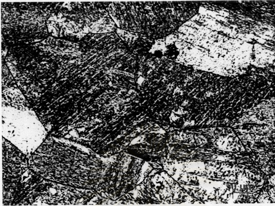
รูปที่4.1 ขอบเกรนเดิมของโครงสร้างออสเทนไนท์หลังการอบให้ร้อนขึ้นอีกที่อุณหภูมิ 1,150 °C เป็นเวลา 30 นาที
