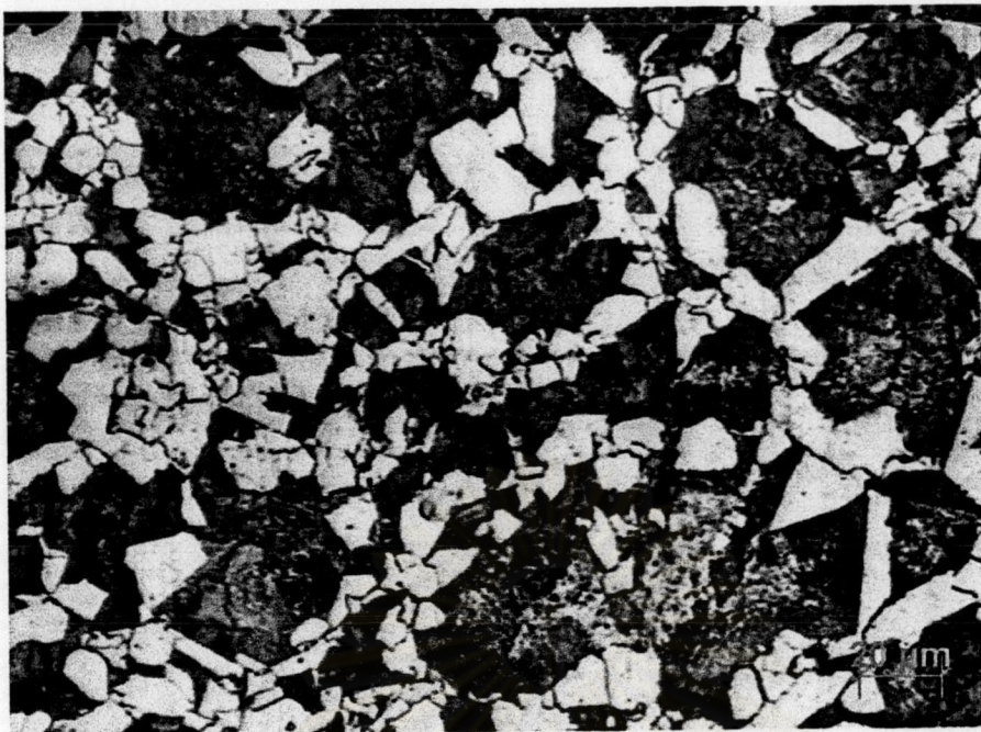
รูปที่ 4.9 โครงสร้างเฟอร์ไรท์-เพิร์ลไลท์ หลังการอบให้ร้อนขึ้นอีกที่อุณหภูมิ 1,150 °C รีดหยาบ 42% ที่อุณหภูมิ 1,100 °C และรีดละเอียดด้วยปริมาณ 53.3% ที่อุณหภูมิ 1,000 °C แล้วเย็นตัวด้วยอัตราการเย็นตัว 1 °C/sec. ไปม้วนเก็บที่อุณหภูมิ 500 °C/sec.
