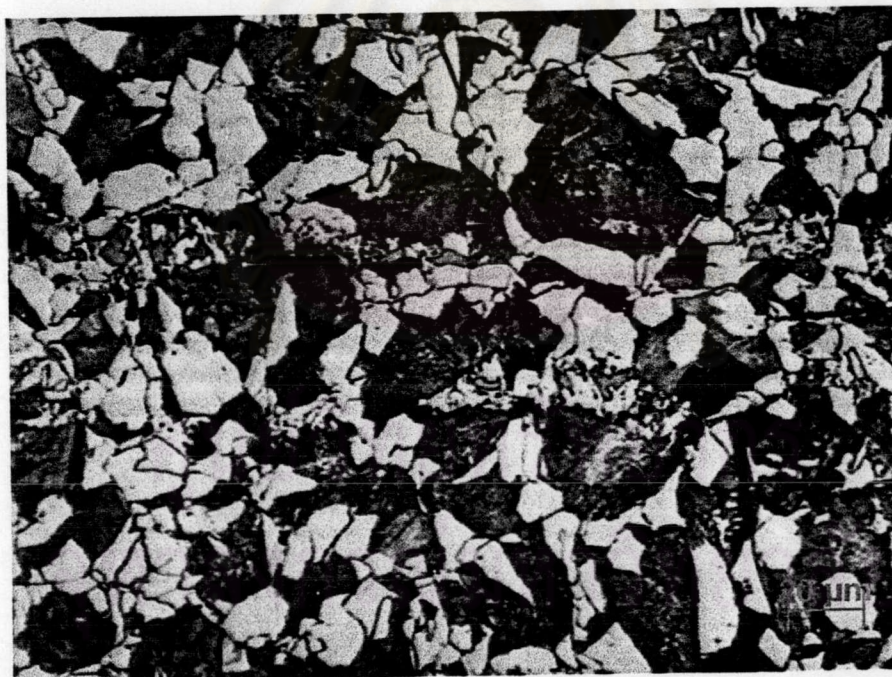
รูปที่ 4.4 โครงสร้างเฟอร์ไรท์-เพิร์ลไลต์ หลังการอบให้ร้อนขึ้นอีกที่อุณหภูมิ 1,150^{\circ}\text{C} รีดหยาบ 42% ที่อุณหภูมิ 1,100^{\circ}\text{C} และรีดละเอียดด้วยปริมาณ 53.3% ที่อุณหภูมิ 1,000^{\circ}\text{C} แล้วเย็นตัวด้วยอัตราการเย็นตัว 1^{\circ}\text{C}/\text{sec} . ไปม้วนเก็บที่อุณหภูมิ 400^{\circ}\text{C}/\text{sec} .
