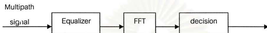
รูปที่ 6.1 สัญญาณถูกปรับแต่งโดยอีควอไลเซอร์ก่อนผ่านการแปลงฟูริเยร์
