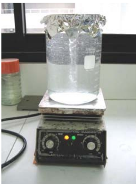
ภาพที่ 8 แผ่นร้อนและเครื่องปั่นผสม hot plate and stirrer, Stuart Scientific รุ่น SM 26
