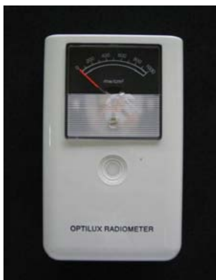
ภาพที่ 14 เครื่องวัดความเข้มแสง รุ่น 100 Curing Radiometer, SdsKerr, USA
