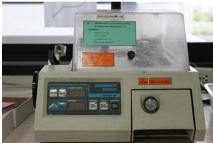
ภาพที่ 9 เครื่องตัดพื้นความเร็วต่ำ (Low speed Cutting machine) ISOMET 1000, BUEHLER, USA
