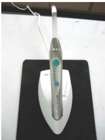
ภาพที่ 13 เครื่องฉายแสง LED ยี่ห้อม Elipar S10, 3M, ESPE
