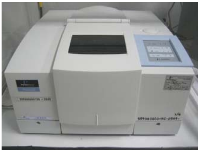
ภาพที่ 11 เครื่องอินฟราเรดสเปกโทรสโกปี (Fourier transform infrared spectroscopy; FT-IR Spectrometer, Spectrum One, PerkinElmer)
