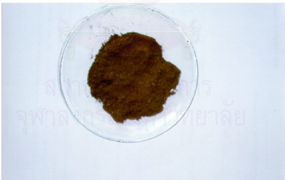
รูปที่ 3.3 ลักษณะของตะกอนน้ำเสียจากโรงงานอุตสาหกรรม
