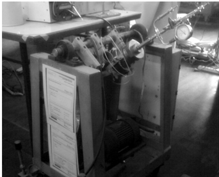
รูปที่ 3.2 ชุดทดลองประกอบด้วยชุดควบคุมอุณหภูมิแบบดิจิทัล และเครื่องเขย่า
