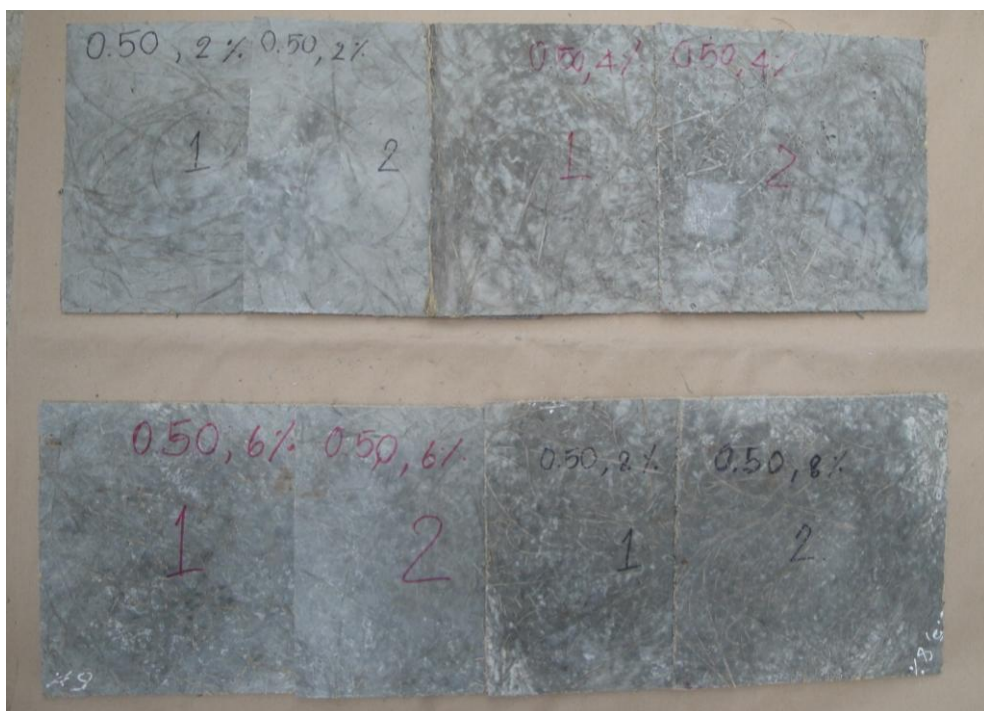
ภาพที่ ข-4 แผ่นซีเมนต์เสริมเส้นใยกาบหมากก่อนการทดสอบที่อัตราส่วนน้ำต่อซีเมนต์ 0.50
