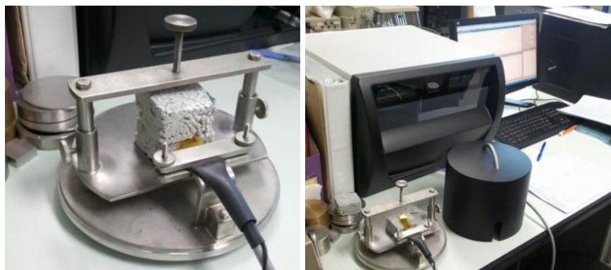
ภาพที่ 3.11 การทดสอบค่าการนำความร้อนของแผ่น
