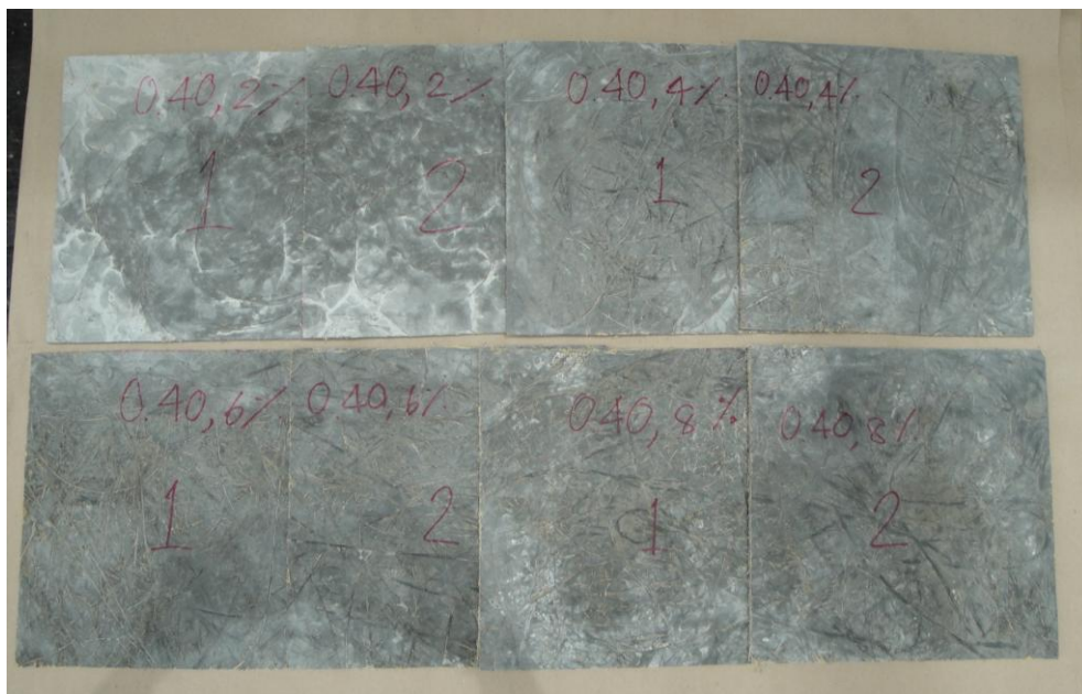
ภาพที่ ข-2 แผ่นซีเมนต์เสริมเส้นใยกาบหมากก่อนการทดสอบที่อัตราส่วนน้ำต่อซีเมนต์ 0.40
