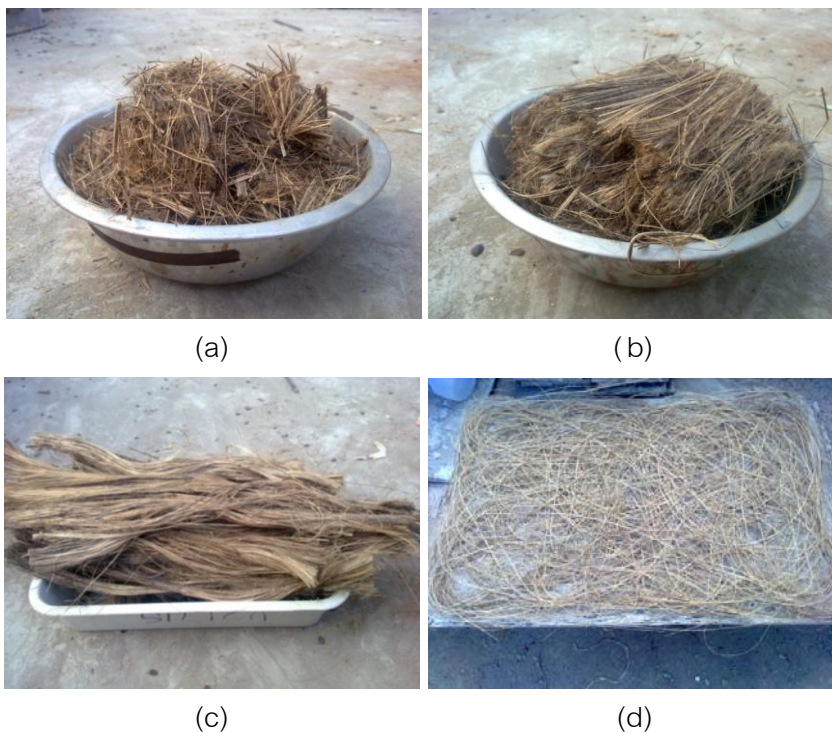
ภาพที่ 3.3 แสดงเส้นใยกาบหมากที่ใช้ในการทดสอบ (a) (b) และ(c) เส้นใยกาบหมากตัดตามขนาดต่างๆ (d) เส้นใยกาบหมากที่สานเป็นแผ่นแล้ว
