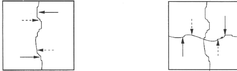
ภาพที่ 3.9 ตำแหน่งการวัดความหนาที่รอยแตกหักของชิ้นทดสอบสี่เหลี่ยมจัตุรัส [53]
