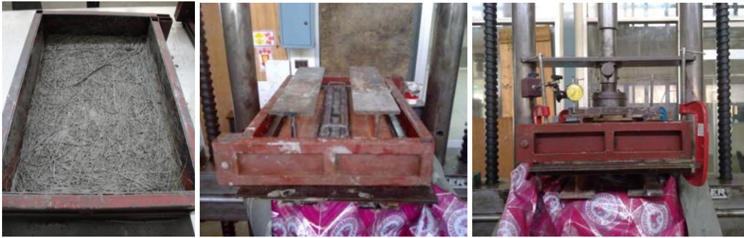
ภาพที่ 3.7 การขึ้นรูปชิ้นทดสอบโดยการตัดความดันด้วยเครื่องตัดไฮดรอลิก
