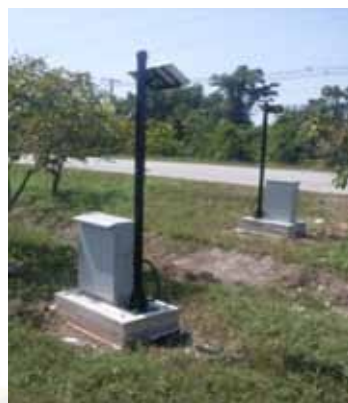
ภาพที่ 3.4 เครื่องนับปริมาณการจราจร อัตโนมัติแบบใช้เซลล์สุริยะแทนแบตเตอรี่
