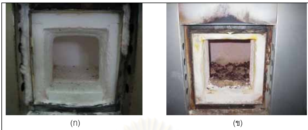
ภาพที่ 3.4 (ก) เตาเผาฟลอยเติมสารประกอบเบริลเลียม (ข) เตาเผาฟลอยเติมสารประกอบตะกั่ว
