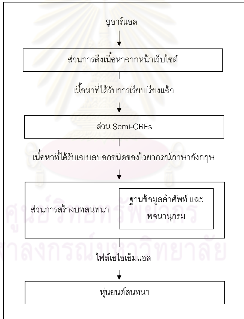
รูปที่ 9 ขั้นตอนการสร้างเนื้อหาบทสนทนาจากหน้าเว็บไซต์สำหรับใช้งานในหุ่นยนต์สนทนา
