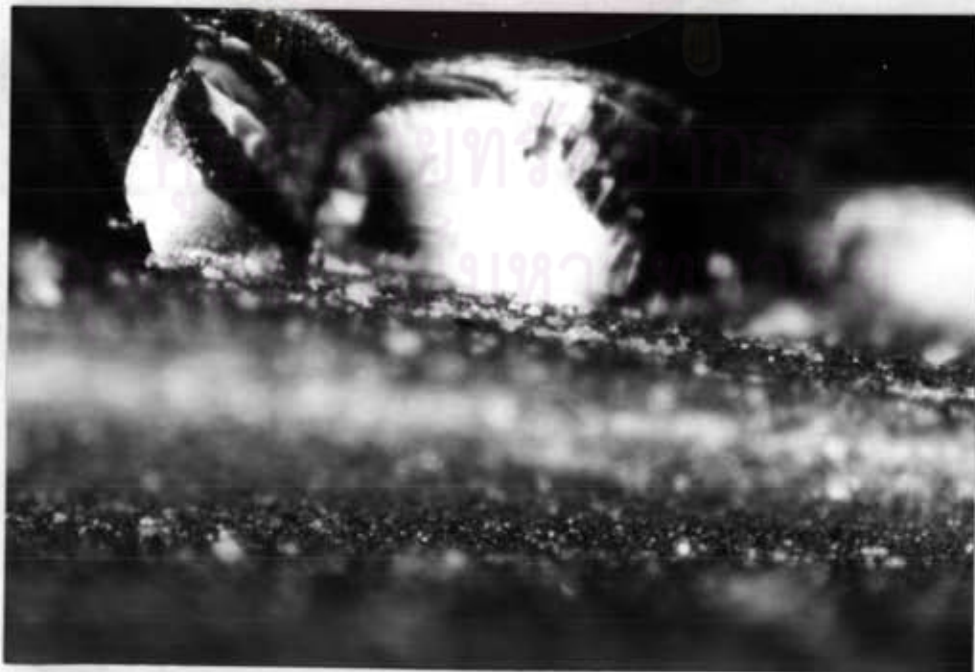
รูปที่ 4.5 ปากร่องที่แตก ในช่วงความเร็วป้อนตัด 0.3 -0.4 มิลลิเมตรต่อวินาที
