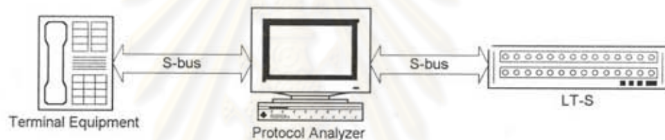
รูปที่ 3.5 แสดงการจุดต่อ Protocol Analyzer เข้ากับอุปกรณ์สื่อสารปลายทางและ LT-S
