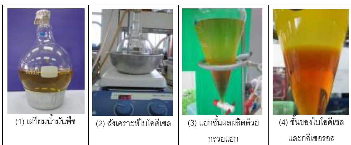
ภาพที่ 3.3 การเตรียมไบโอดีเซลเพื่อใช้ในการดูดซับ
