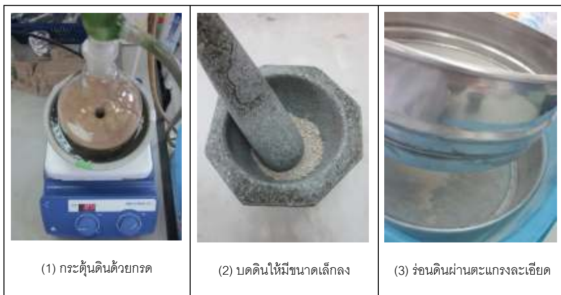
ภาพที่ 3.2 การเตรียมดินสเม็คไทต์เพื่อใช้ในการดูดซับ
