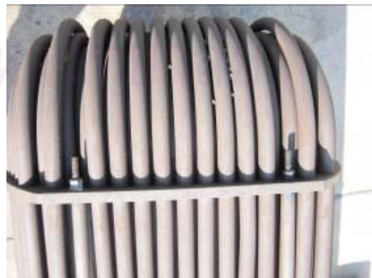
รูปที่ 2.2 ตะกรันในเครื่องแลกเปลี่ยนความร้อนของโรงกลั่นน้ำมันดิบแบบไลท์ครูด (Light Crude)
