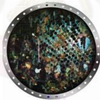
รูปที่ 2.1 ไมโครฟาวลิงในเครื่องแลกเปลี่ยนความร้อนของโรงไฟฟ้าพลังน้ำ
