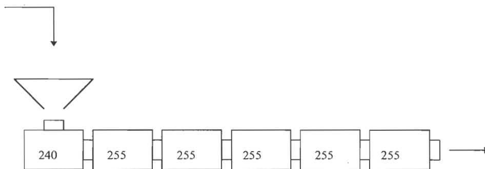
รูปที่ 3.1 ช่วงอุณหภูมิต่างๆ ในการอัดรีด (องศาเซลเซียส)
