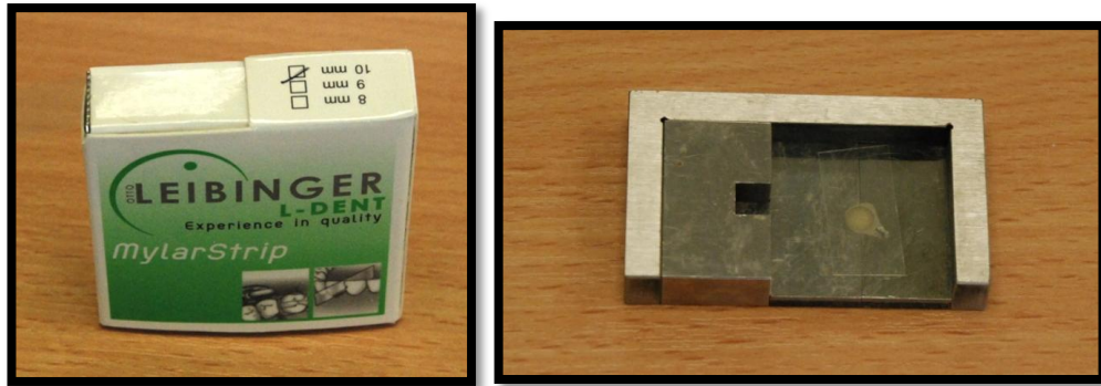
ภาพที่ 10,11 แสดงเมทริกซ์ใส และการปิดด้านบนชิ้นงานด้วยเมทริกซ์ใส
