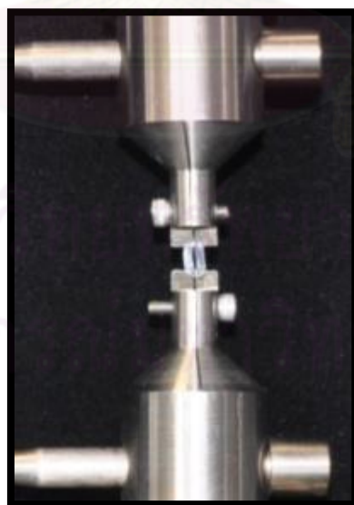
ภาพที่ 21 แสดงหัวจับเฉพาะชิ้นในเครื่องวัดล้อยด์เพื่อวัดแรงดึงของยางวงแหวน
