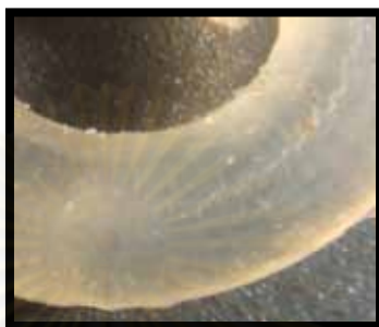
ภาพที่ 29 การสีของยางวงแหวนรูปทรงกลมด้านในกลมความแข็งผิว 50 ชอร์เอ
