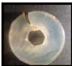
ภาพที่ 34 แสดงลักษณะการขาดของยางวงแหวนเส้นผ่าศูนย์กลางวงในหกลีเยม
