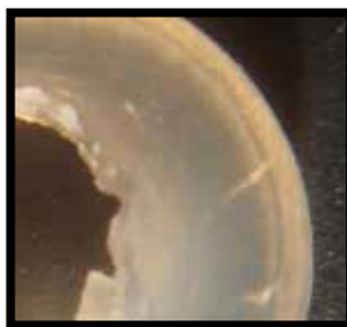
ภาพที่ 31 การสีของยางวงแหวนรูปทรงกลมด้านในกลมความแข็งผิว 70 ชอร์เอ
