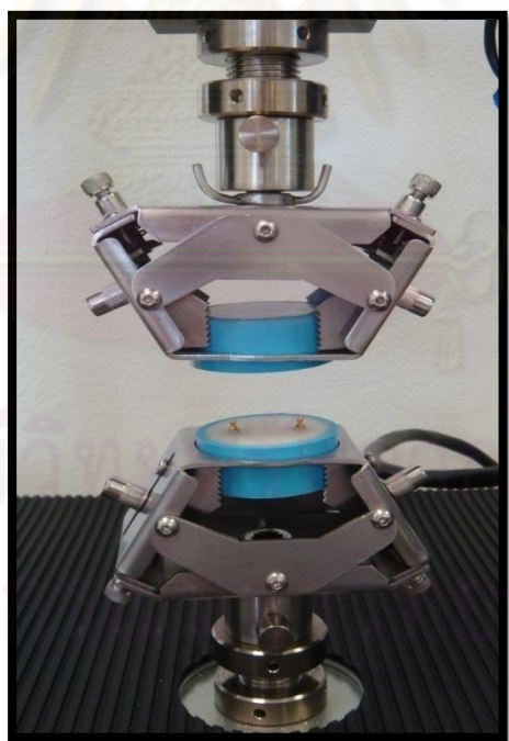
ภาพที่ 18 แสดงลักษณะการดึงชิ้นงานขึ้นเพื่อวัดค่าแรงในการยึดอยู่ของยางวงแหวน
