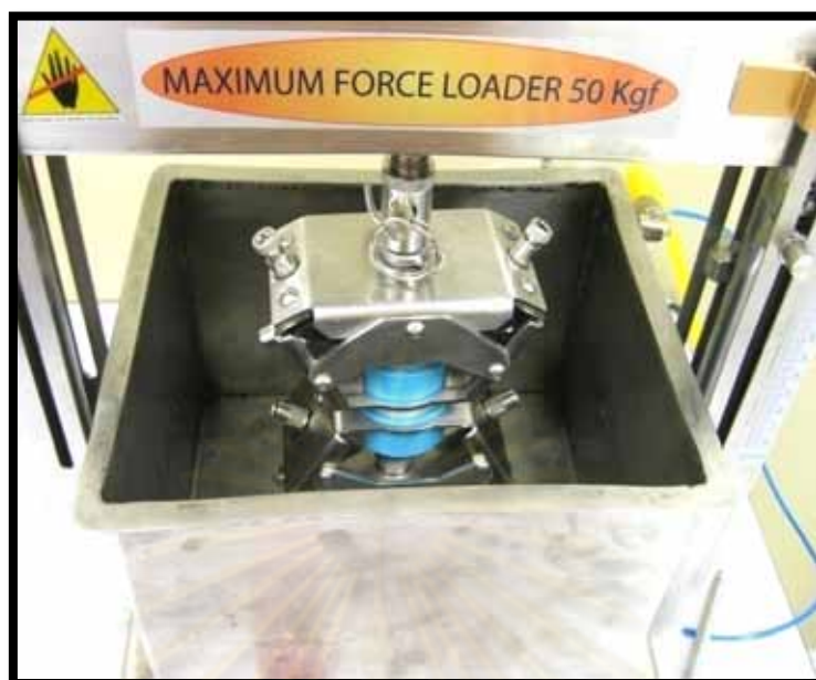
ภาพที่ 19 แสดงลักษณะหัวจับเฉพาะชิ้นงานขณะใส่ในเครื่องแรงอายุการใช้งาน
