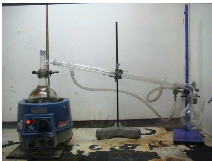
รูปที่ 3.1 การติดตั้งอุปกรณ์การกลั่นมอโนเมอร์
