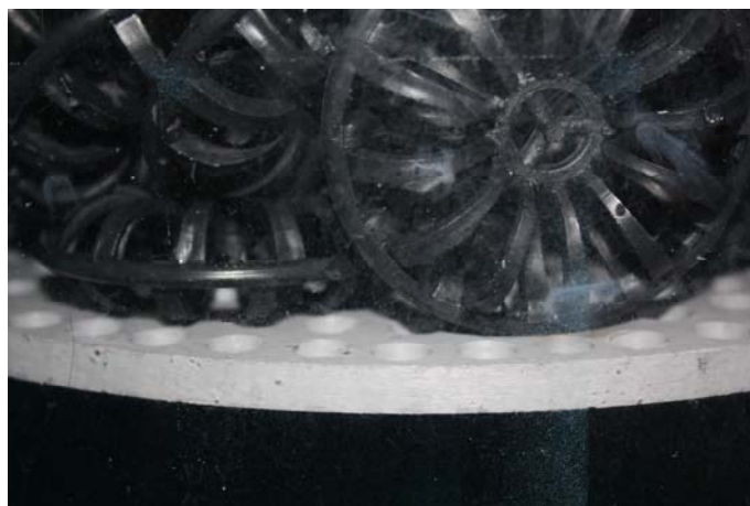
รูปที่ 3.8 แผ่นรองรับตัวบรรจุ (Packing Support)
