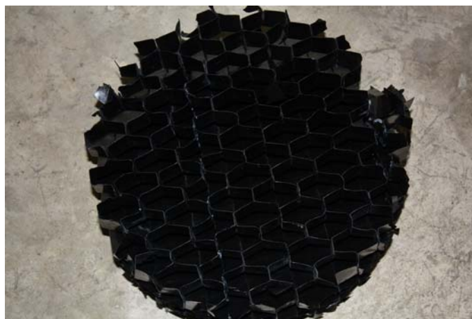
รูปที่ 3.11 อุปกรณ์ดักละอองน้ำ (Mist Eliminator)
