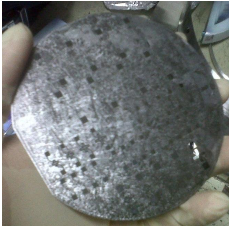
ภาพที่ 3.13 ชิ้นงานหลังจากการสร้างผิวDLCหนา 1 ไมโครเมตร และNiTi หนา 3 ไมโครเมตร
