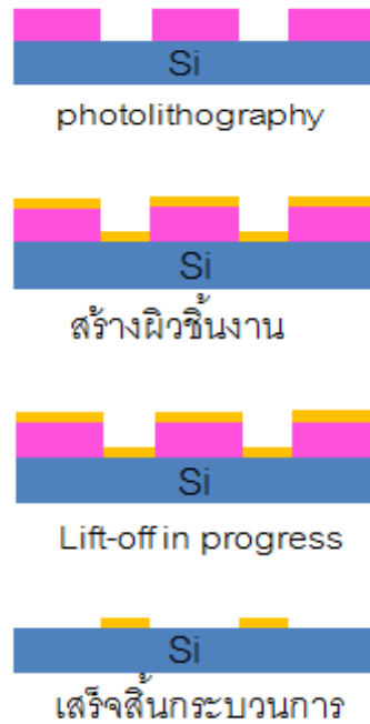
ภาพที่ 3.4 ขั้นตอนกระบวนการ lift-off
