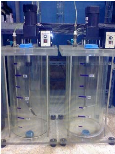
รูปที่ 3.4.5-2 ถังหมักไร้อากาศที่ใช้ในการทดลองที่ 3
