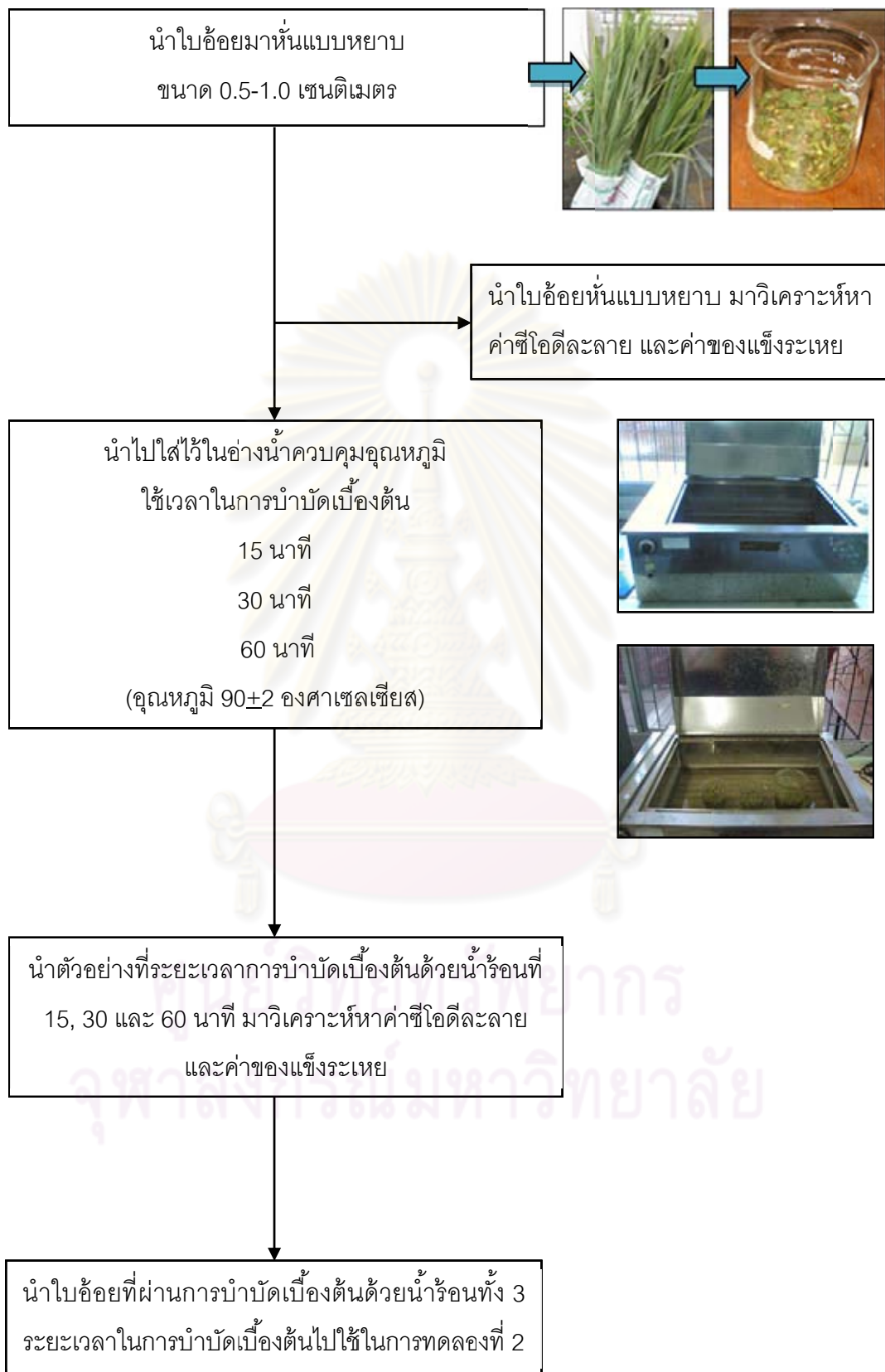
รูปที่ 3.5.1-2 ขั้นตอนการทดลองที่ 1 ชุดที่ 2
