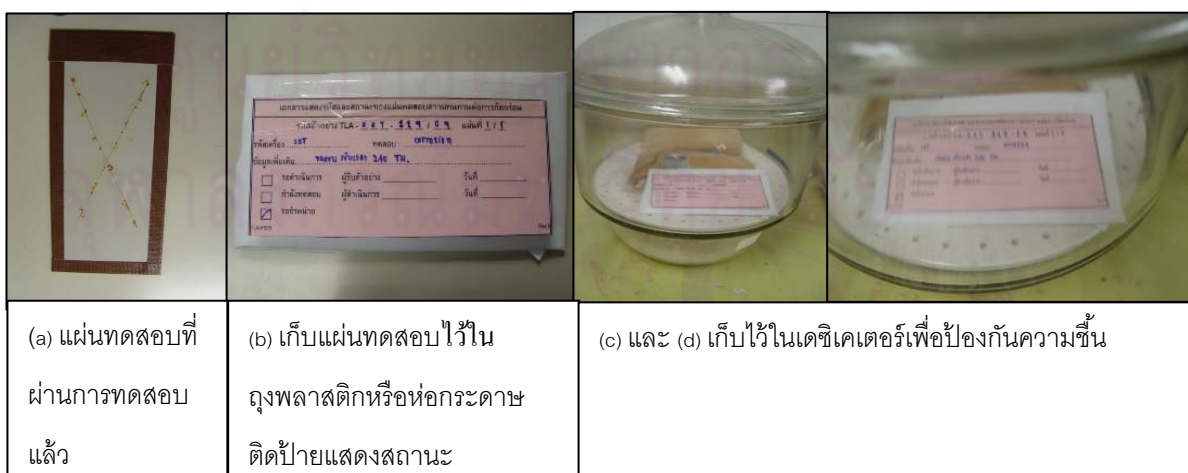
รูปที่ 5.2 ขั้นตอนการการควบคุมสภาวะแผ่นทดสอบหลังทำการปรับปรุง
