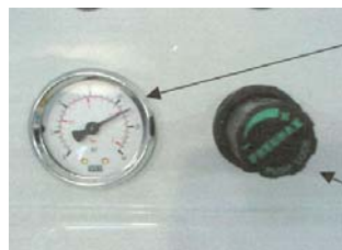
รูปที่ 2 Air Pressure Gauge &amp; Regulator
