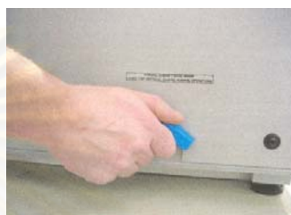
รูปที่ 4 Drain The Cabinet
