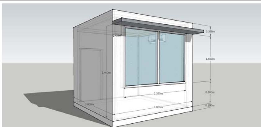
ภาพที่ 3.1 แสดงอุปกรณ์บังแดดจากการคำนวณค่า SC กรณีศึกษาที่ 1 (SC 1 )
