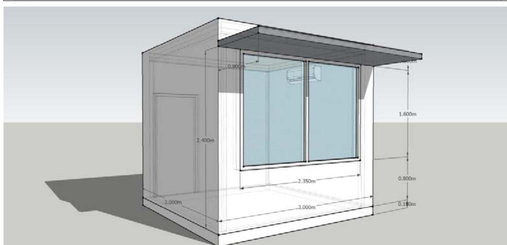
ภาพที่ 3.2 แสดงอุปกรณ์บังแดดจากการคำนวณค่า SC กรณีศึกษาที่ 2 ( SC_2 )
