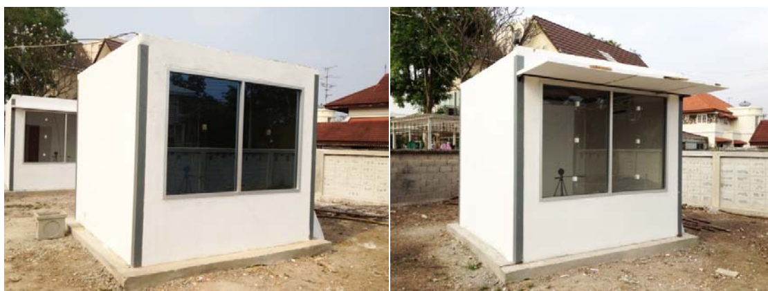
ภาพที่ 4.2 ห้องทดลองพลังงาน 1 (SHGC 2 mockup) และห้องทดลองพลังงาน 2 (SC 2 mockup)
