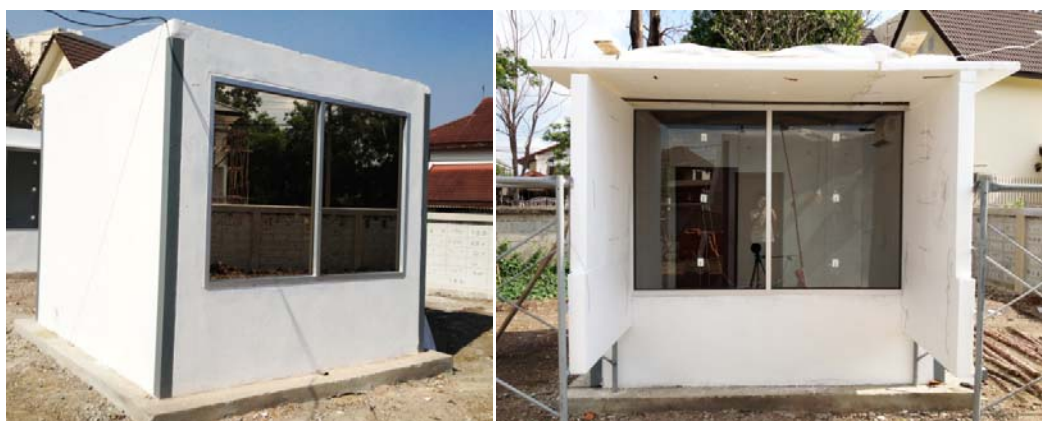
ภาพที่ 4.3 ห้องทดลองพลังงาน 1 (SHGC 3 mockup) และห้องทดลองพลังงาน 2 (SC 3 mockup)
