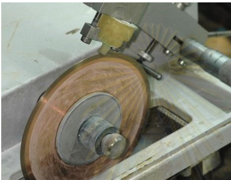
ภาพที่ 18 การตัดชิ้นงานด้วยเครื่องตัดพื้นความเร็วต่ำ
