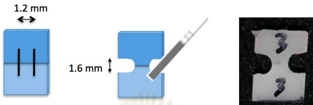
ภาพที่ 20 การเตรียมชิ้นงานให้มีความเว้าด้วยเข็มกรอกกากเพชร
