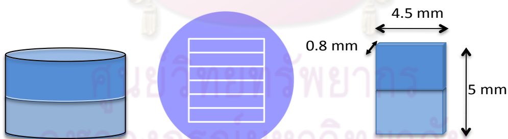
ภาพที่ 19 การตัดชิ้นงานรูปทรงกระบอกให้เป็นรูปแผ่นที่มีความหนา 0.8 มิลลิเมตร
