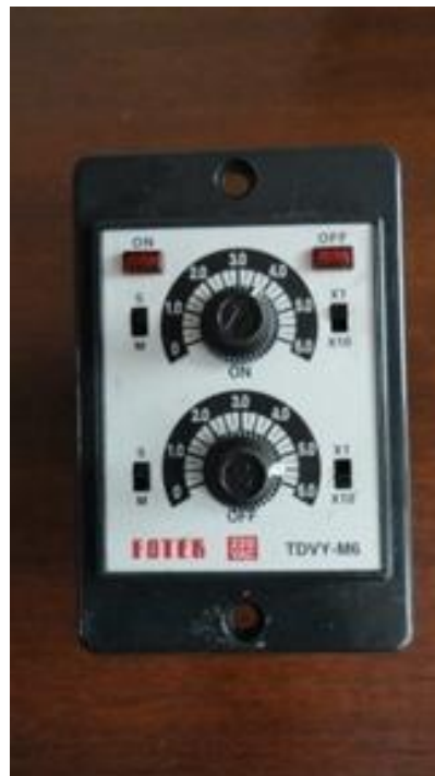
รูปที่ 4.7 อุปกรณ์หน่วงเวลาในการเปิด – ปิดโซลินอยด์วาล์ว
