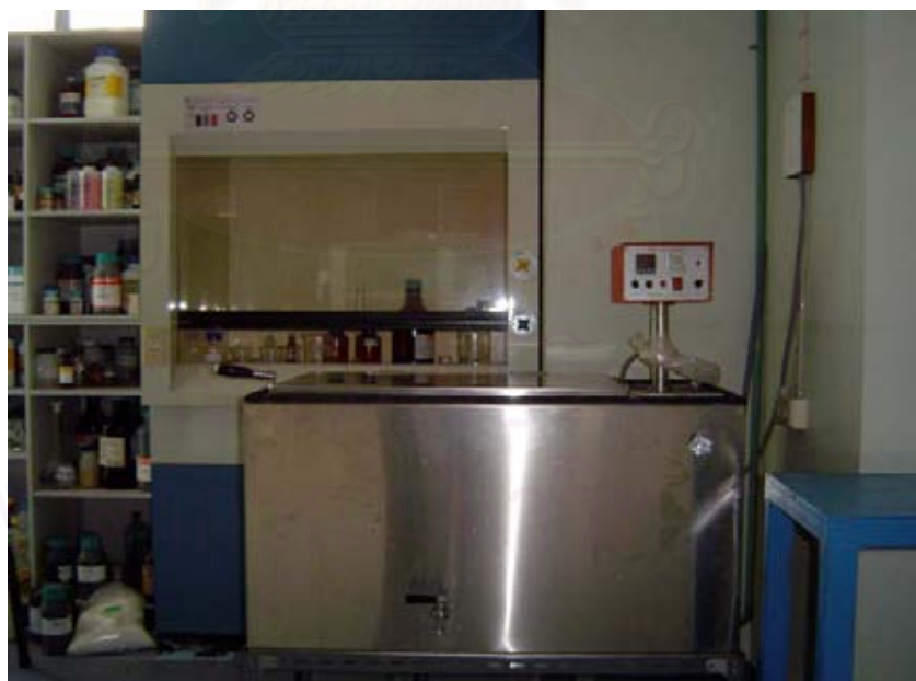
รูปที่ 3.8 เครื่องทดสอบความคงทนของสีผ้าต่อการซัก RotaWash รุ่น M 228
