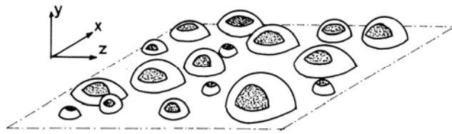
ภาพที่ 2.15 พื้นที่ผิวสัมผัสเมื่อเกิดการเคลื่อนตัวของรอยร้าว [5]
