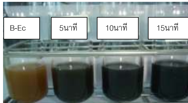
ภาพ ง-4 สีที่เกิดจากความหนาแน่นของกระแสไฟฟ้าที่ 0.02\text{A}/\text{cm}^2
