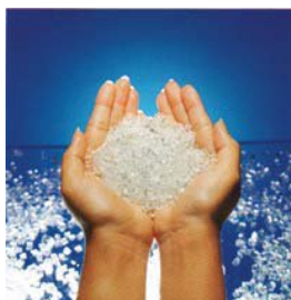
รูปภาพที่ 2.24 ลักษณะการแตกของกระจกนิรภัยเทมเปอร์ (Temper Safety Glass)
