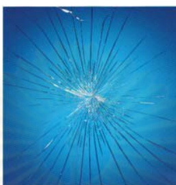
รูปภาพที่ 2.25 ลักษณะการแตกของกระจกนิรภัย (Heat Strengthened Glass)
