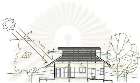
รูปภาพที่ 2.4 แสดงการป้องกันและลดความร้อนเข้าสู่อาคาร
