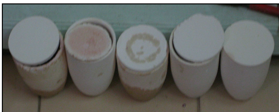
ภาพที่ 2.4 แสดงภาพเบ้าที่ใช้ในกระบวนการปรับปรุงพลอยด้วยความร้อน
