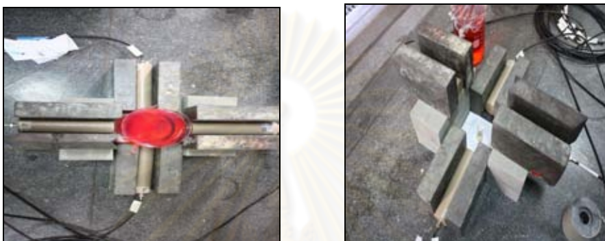
รูปที่ 3.3 การจัดวางหัววัดสำหรับการทดสอบการผสมกับน้ำมัน
