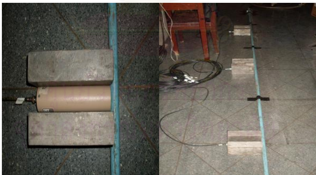
รูปที่ 3.6 การจัดวางหัววัดสำหรับการวัดอัตราการไหล
