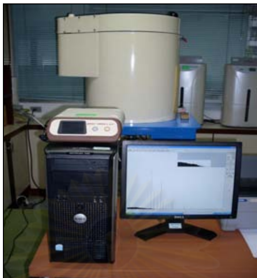
รูปที่ 3.2 เครื่องแกมมาสเปกโทรมิเตอร์
