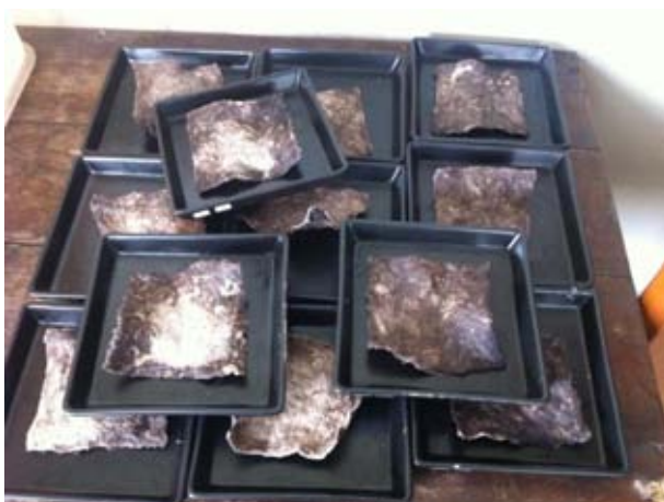
ภาพที่ ง.9 ตัวอย่างวัสดุดูดซับที่อบนานเกินเวลาที่กำหนดไว้
