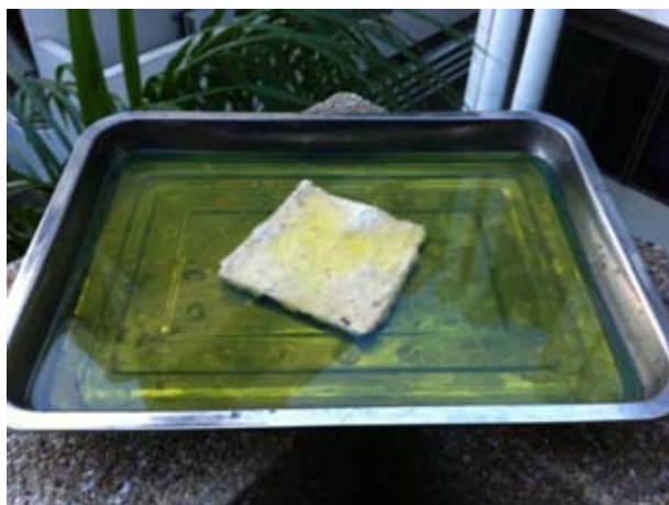
ภาพที่ ๓.๖ ตัวอย่างลักษณะการทดลองดูดซับน้ำมัน
