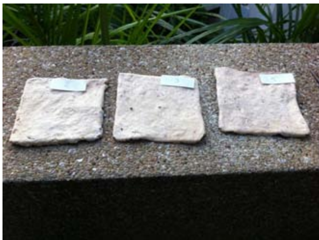
ภาพที่ 4.2 ตัวอย่างของตัวดูดซับที่เตรียมขึ้น (หลังอบแห้ง)
