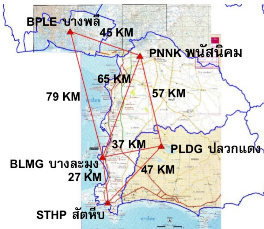
ภาพที่ 2-7 แผนที่แสดงตำแหน่งของหมุดอ้างอิงในระบบ DOL GPS NET (ดัดแปลงจาก ไพโรจน์ เผือกวิไล (2551))
