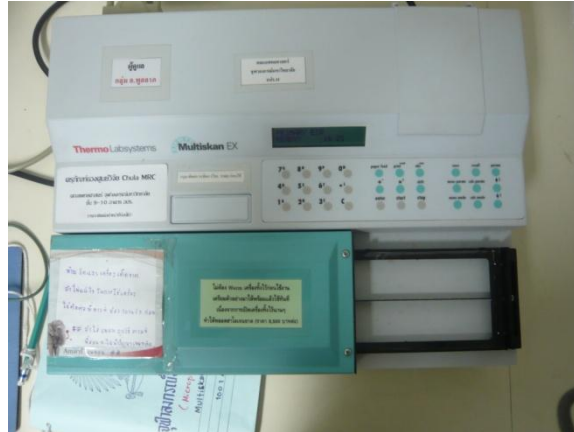
เครื่องวัดความเข้มแสง (Spectrophotometer) ยี่ห้อ Thermo Lab system รุ่น Multiskan EX
