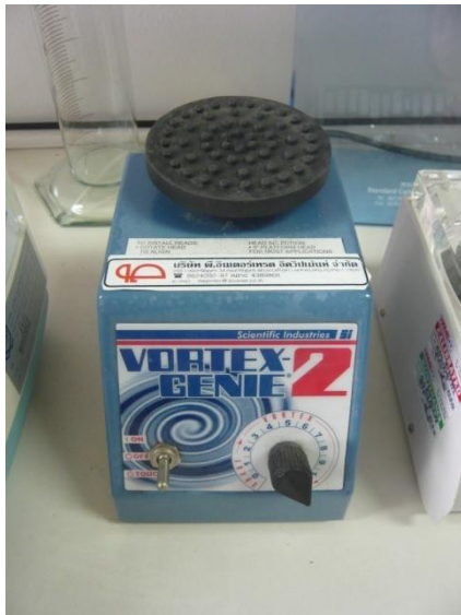
เครื่องผสมตัวอย่างให้เข้ากัน ยี่ห้อ Vortex genic 2
