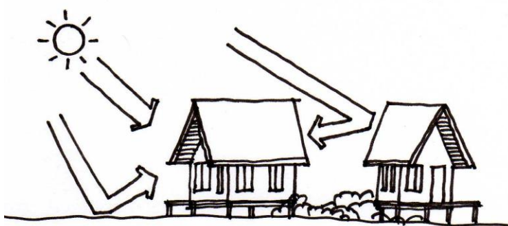
ภาพที่ 5.6 อิทธิพลความร้อนจากสิ่งแวดล้อม
