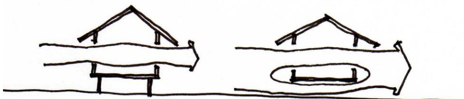
ภาพที่ 5.9 การแก้ปัญหาความร้อนด้วยการยกพื้น
