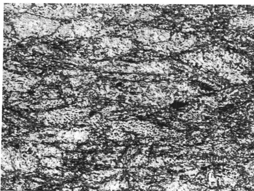
รูปที่ 4.4 โครงสร้างจุลภาคของชิ้นงานหลังการรีดละเอียดที่อุณหภูมิ 860 °C ปริมาณการรีด 53.3%
