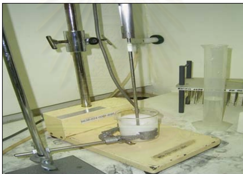
รูปที่ 3.2 การกวนสารโพลีเมอร์เพื่อให้ได้ขนาดระดับอนุภาคนาโนด้วยเครื่องกวนความเร็ว 2500 – 3000 รอบ/นาที
