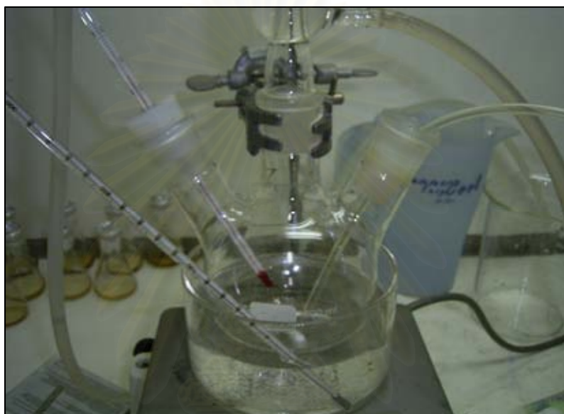
รูปที่ 3.3 รีแอกเตอร์ชุดที่ 2 ที่ประกอบด้วยขวดก้นกลม 3 คอ สำหรับเชื่อมต่อกับส่วนต่าง ๆ และแช่ภายในอ่างซิลิโคนเจลเพื่อรักษาระดับอุณหภูมิให้คงที่ในขณะที่สังเคราะห์
