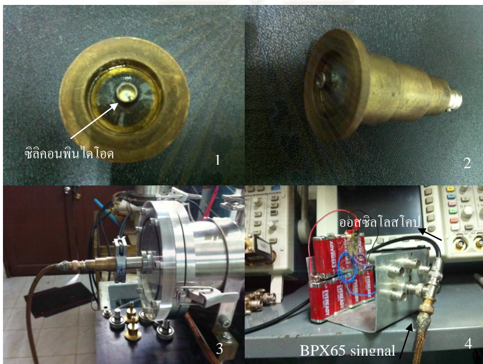
รูปที่ 4.2.16 ภาพการติดตั้งซีลิกอนพินไดโอด
