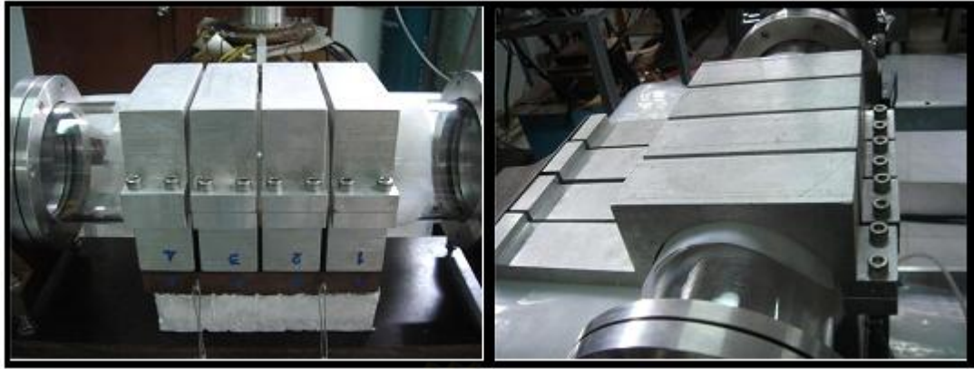
รูปที่ 4.1.8 ภาพแสดงขดลวดรอบเดียวที่สร้างและทำการติดตั้งแล้วเสร็จ
