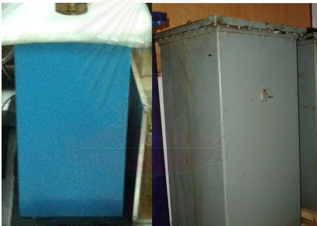
รูปที่ 2.5 ภาพของตัวเก็บประจุความจุสูงของพีไอซีพี(ซ้าย) และเครื่องที่ด้าพินซ์(ขวา)[1]
