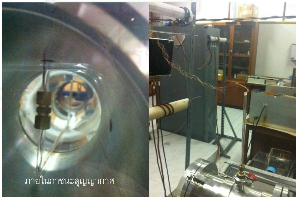
รูปที่ 4.2.12 ภาพการจัดวางหัววัดสนามแม่เหล็กในการทดลอง
