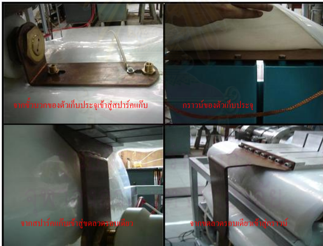
รูปที่ 4.1.9 ภาพข้อต่อสำหรับใช้เป็นทางเดินของกระแสไฟฟ้า
