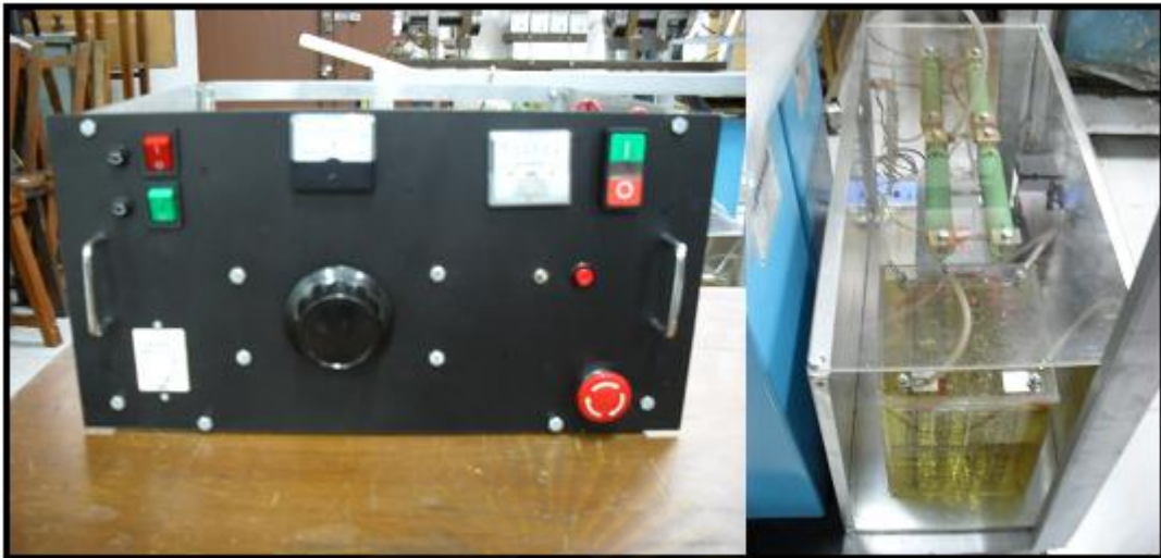
รูปที่ 4.1.12 ภาพเครื่องชาร์จประจุความต่างศักย์สูง แสดงส่วนควบคุม (รูปซ้าย) และส่วนไฟฟ้าความต่างศักย์สูง(รูปขวา)
