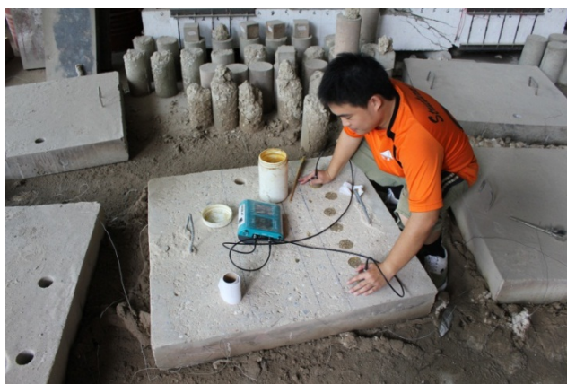
ภาพที่ 21 การทดสอบด้วยวิธีคลื่นอัลตราโซนิก
