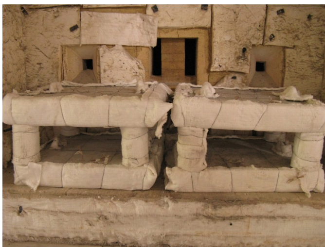
ภาพที่ 13 การวางชิ้นตัวอย่างในเตา
