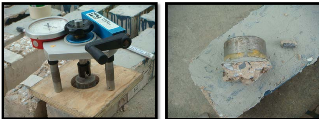
ภาพที่ 6 การทดสอบแรงดึง (ASTM D4541)
