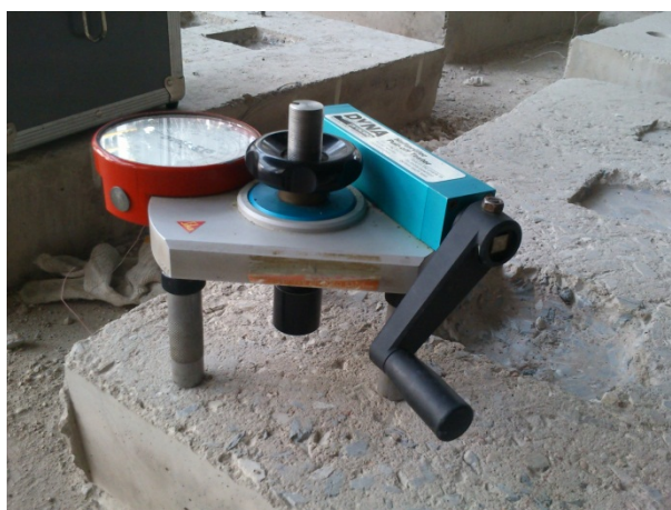
ภาพที่ 32 เครื่องดึงทดสอบ (Tensile Loading) สำหรับการทดสอบดึงทดสอบ
