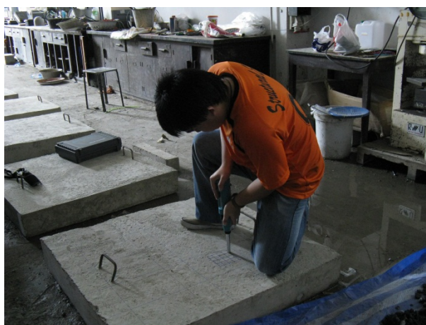
ภาพที่ 23 การทดสอบด้วยค้อนกระแทก
