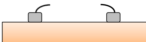
ภาพที่ 7 การทดสอบ Indirect Test
