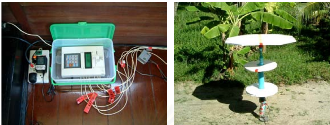
ภาพที่ 3.3 เครื่องบันทึกข้อมูลอัตโนมัติ (data logger) รุ่น Tenex model 045-38 S และการติดตั้งอุปกรณ์เก็บข้อมูลภายนอกอาคาร
