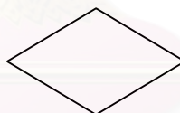
รูปที่ 3.17 สัญลักษณ์การตัดสินใจในแผนภาพกระบวนการทำงาน
