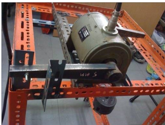
ภาพที่ ข.9 การติดตั้ง torque transducer บนโครงสอบเทียบ
