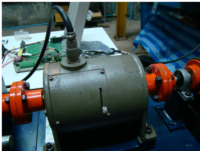
ภาพที่ ค.3 การยึดสลักเกลียวที่คัปปลิ่งที่เชื่อมต่อเพลลาจากห่องเกียร์กับอุปกรณ์วัดแรงบิด
