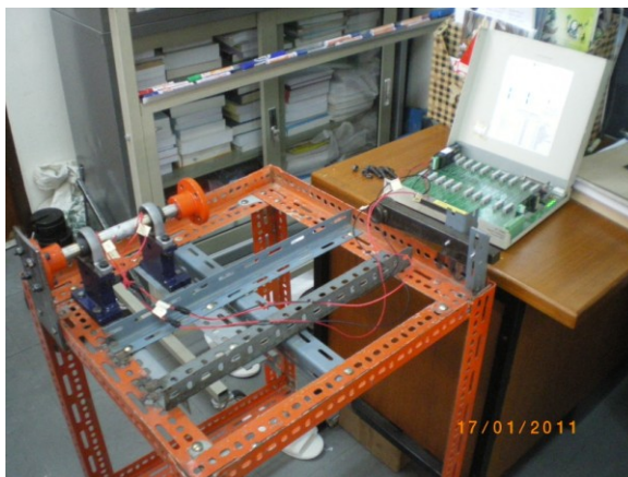
ภาพที่ ข.5 การติดตั้งเพลลาบนโต๊ะสำหรับการปรับเทียบ
