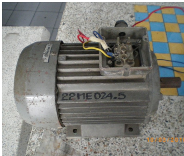
ภาพที่ ๗.7 มอเตอร์ไฟฟ้าตัวขับเคลื่อนน้ำมัน
