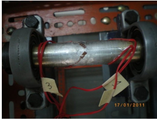
ภาพที่ ข.2 ตำแหน่งการติด strain gage ที่เพลลาจริง
