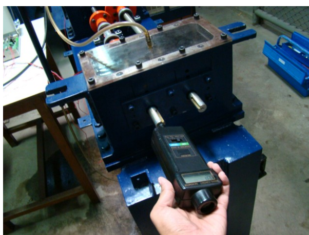
ภาพที่ ค.7 การวัดความเร็วรอบการหมุนของเพลลาโดยใช้เครื่องวัดความเร็วรอบแบบสัมผัส
