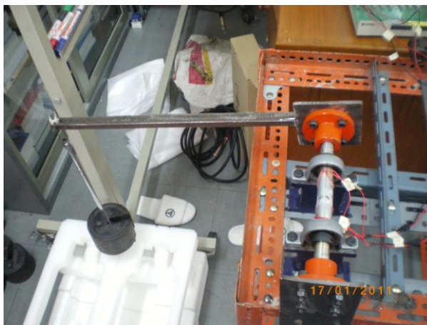
ภาพที่ ข.7 การถ่วงน้ำหนักที่แขนถ่วงน้ำหนักเพื่อให้แรงบิดที่เพลลา
