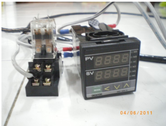
ภาพที่ ๑.11 ชุดอุปกรณ์แสดงผลและควบคุมอุณหภูมิ
