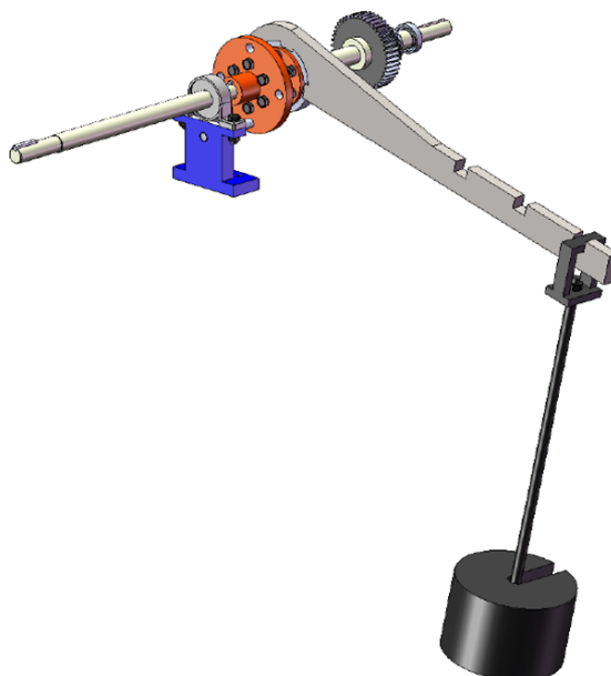
ภาพที่ ค.23 ใส่สลักเกลียวในขณะที่รูเจาะตรงศูนย์
