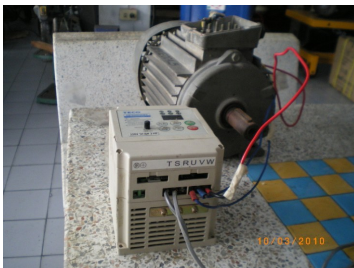
ภาพที่ ๗.8 Inverter ควบคุมมอเตอร์ขับเคลื่อนน้ำมัน
