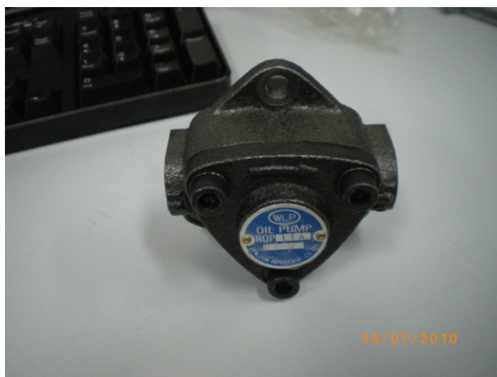
ภาพที่ ๕.6 ปั๊มน้ำมันหล่อลื่น
