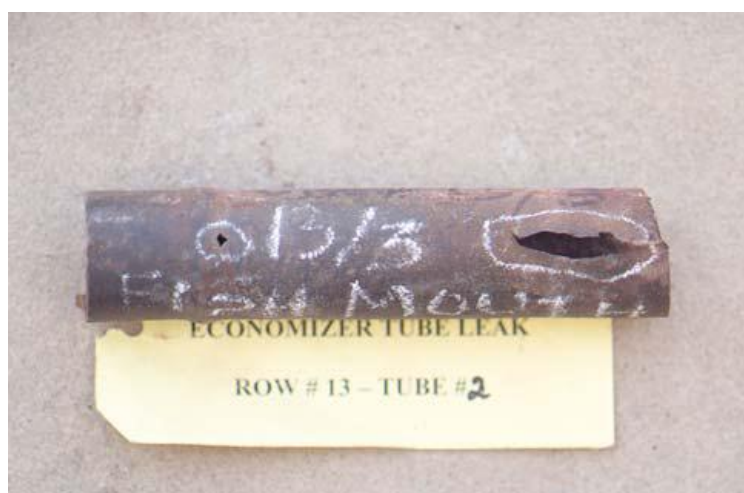
ภาพที่ 2.3 รอยแตกกรุปพื้นปลาที่เกิดกับท่อในอีโคโนไมเซอร์ แถวที่ 13
