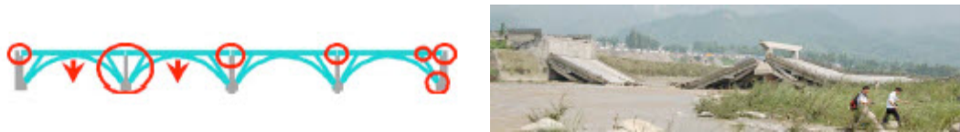
รูปที่ 2.13 จุดที่เกิดความเสียหายของสะพาน Xiaoyudong (Lin และคณะ, 2010)
