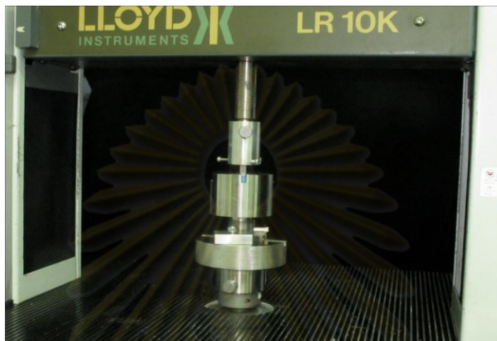
รูป 18 การทดสอบกำลังแรงยึดติดด้วยเครื่องทดสอบแรงแบบอเนกประสงค์
