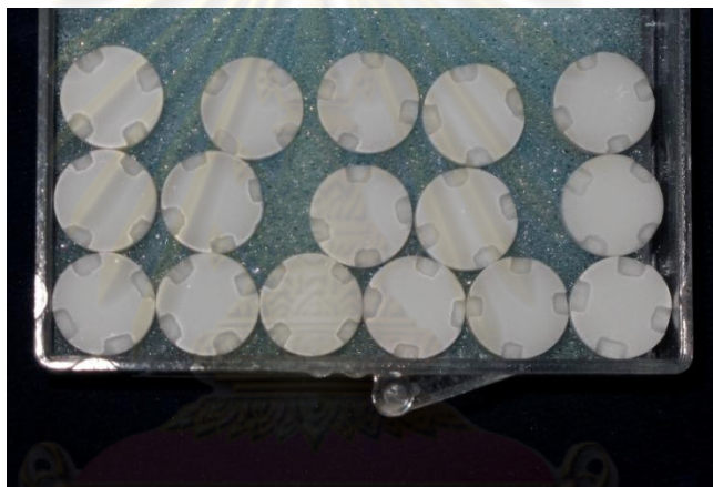
รูป 9 ชิ้นงานเซอริโคเนียหลังการเผา(sinter)
