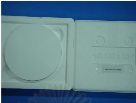
รูป 5 ชิ้นงานเซอริโคเนียก่อนทำการกลึง ขนาด 100x20 มิลลิเมตร
