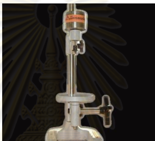
รูป 13 แท่นวางเครื่องทดสอบความแข็งผิวของวัสดุ
