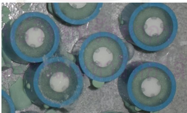
รูป 10 ชิ้นงานเซอริโคเนียยึดในแบบหล่อด้วยอะคริลิก
