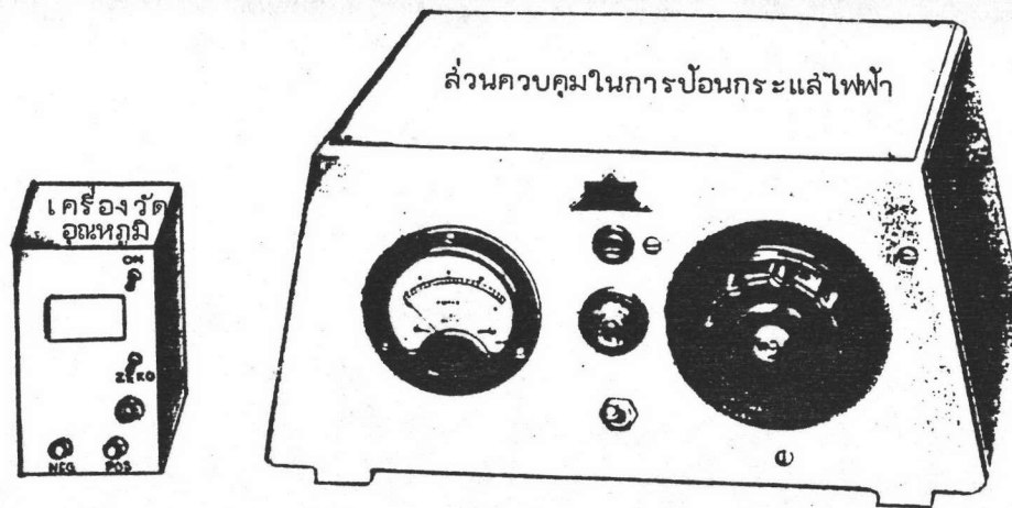
รูป 4.12 ก. ส่วนควบคุมในการป้อนกระแสไฟฟ้าให้กับเครื่องมือต่าง ๆ ของกล้องถ่ายภาพการเลี้ยวเบนรังสีเอ็กซ์โดยผลึกผง แบบ อุณหภูมิสูง UNICAM S.70 และเครื่องวัดอุณหภูมิที่ใช้ต่อกับเทอร์โมคัพเพิล
